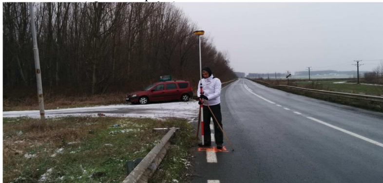
Fig. 4. Măsurători RTK Bază-Rover
